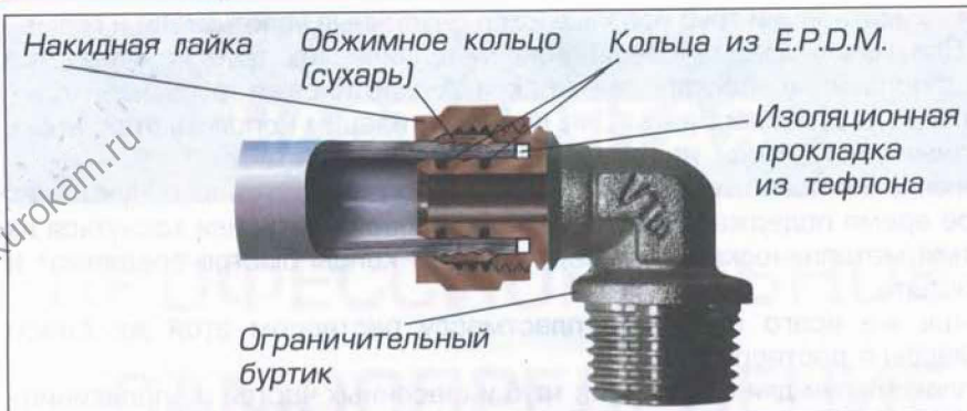
Рис. 196. Соединение металлопластиковой трубы с фитингом (E.P.D.M. – это вид пластмассы: этилен пропилен диен мономер)
